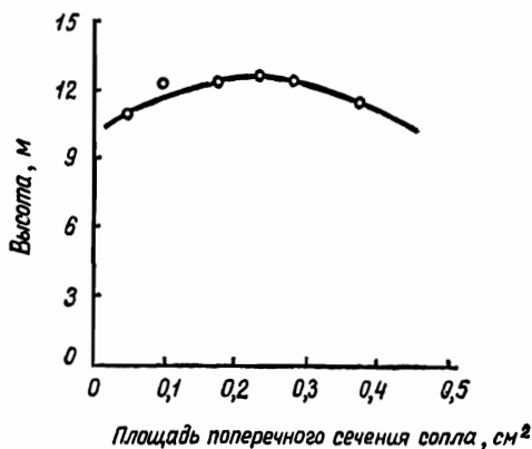
Р и с. 10.5. Влияние площади поперечного сечения сопла на высоту полета ракеты.
